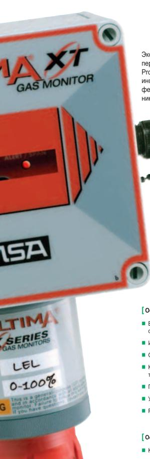
Экономичные стационарные газовые сигнализаторы с возможностью передачи данных при помощи технологии HART Field Communications Protocol. Приборы [с одним каталитическим, электрохимическим или инфракрасным датчиком] осуществляют контроль за наличием в атмосфере взрывоопасных или токсичных газов, а также за возможным снижением содержания кислорода.
