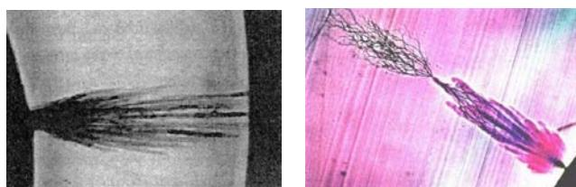
Рис. 1: Слева - разросшееся водяное дерево, справа – образование электрического дерева
