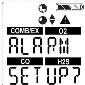
*Рис. 6      Настройка сигнализации*
