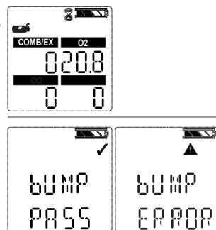
После успешного тестирования с помощью смеси газов, в режиме измерения, в течение 24 часов, отображается символ ✓.
