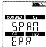
Если срок службы датчика близится к концу, надпись "SPAN PASS" дополняется символом предупреждения [♥]. Символ ♥, вместе с указанием типа газа, измеряемого датчиком с заканчивающимся сроком службы, мигают, при переходе в режим измерения, в течение 15 секунд. Далее символ ♥ отображается непрерывно.
