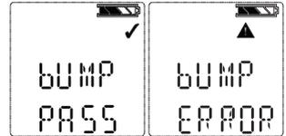
После успешного тестирования с помощью смеси газов, в режиме измерения, в течение 24 часов, отображается символ √.
