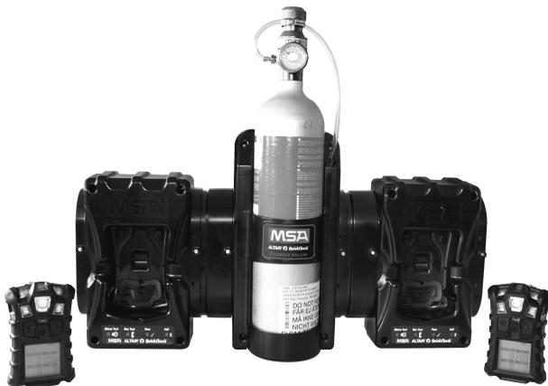
Рис. 2 Настройка испытательного стенда ALTAIR 4 QuickCheck Station
