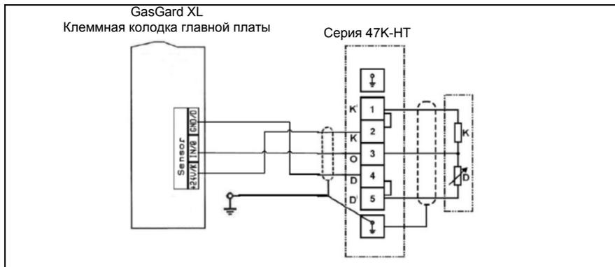
10.5. Схема подключения датчика 47K-НТ к распределительной коробке НТ 11
