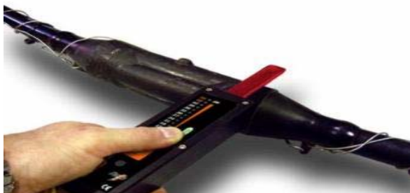
Поиск повреждения ЧР ёмкостным датчиком
