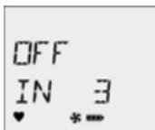
2. Затем детектор снова активируется и выполнит обратный отсчет **CAL** (калибровка). Для входа в режим калибровки продолжайте удерживать кнопку
