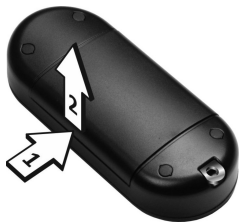
Рисунок 2 - Указания по снятию задней крышки
