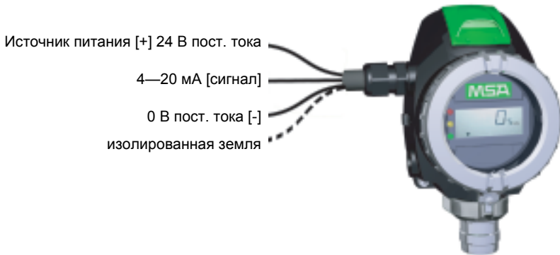
Рис. 5 3-проводное соединение — PrimaX P
