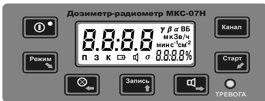
Рис. 1.4.2. Внешний вид лицевой панели пульта дозиметра.
